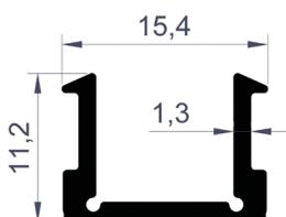
**Perfil de Cubierta de Vidrio Íntegrado Led**
