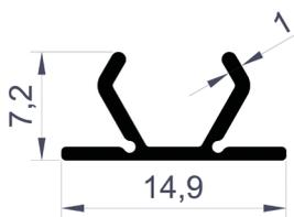
**Perfil de Canalón y Cubierta de Travesaño**
