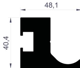
Transmisión Motor 6'Gen Eje Perfil 5
