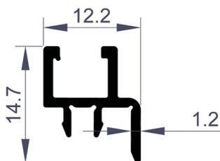
**Perfil Mecha Canalón y Tapa Pared**
