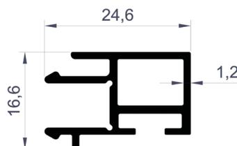
Perfil Espaciador de La Junta del Travesaño de Vidrio
