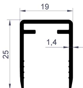
**Perfil de La Cubierta Superior del Panel**
