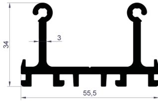
Conexión Vertical, Perfil Adaptador
