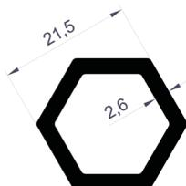
Transmisión Motor 6'Gen Eje Perfil 2
