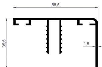
**Perfil de Cubierta de Compresión Lateral**
